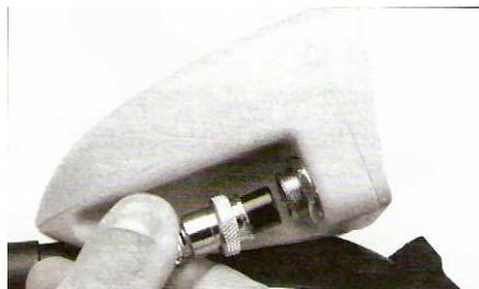
6. Tutti i metal detector ACE hanno le batterie già installate. Far scorrere il coperchio all' indietro per sostituire le batterie.
