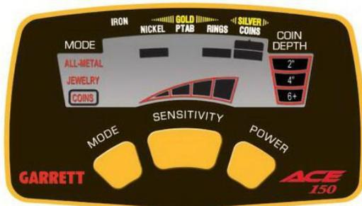
Il metal detector ACE 150 è stato progettato con l'esclusiva tecnologia della Garrett dell'identificazione grafica dell'obiettivo. Essa indica il probabile materiale di cui è composto l'obiettivo rilevato lungo una scala orizzontale che legge da sinistra → metalli a bassa conduttività (ad esempio ferro) a destra → metalli ad alta conduttività (ad esempio monete americane).
