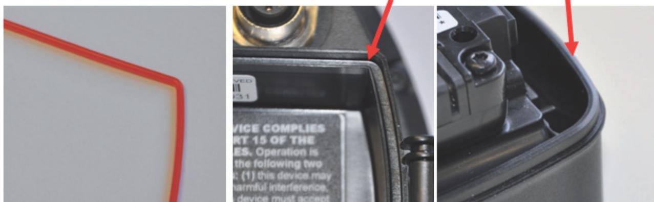
Pulire l'O-ring e la superficie di accoppiamento della batteria ✔️
