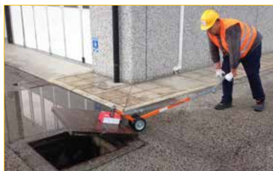
Utilizzo di PM500 per il sollevamento di una piastra d'acciaio dal peso di 300kg.
