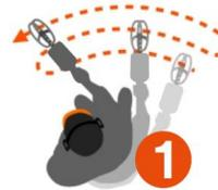
1. Far oscillare la bobina: tenere la bobina a circa 4 cm dal suolo e assicurarsi che le oscillazioni si sovrappongano per coprire completamente l'area.
