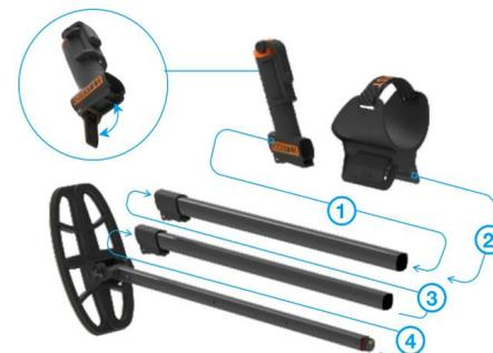
Rilasciare la leva di bloccaggio situata nella parte inferiore della maniglia. Quindi, spingere la maniglia nell'asta superiore. Quindi, premere verso il basso la leva di bloccaggio per fissarla in posizione. Inserire il braccio nel pulsante dell'asta superiore e serrarlo saldamente utilizzando un cacciavite a croce.
